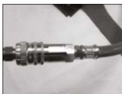
Raccordement du tuyau à l'ARI
